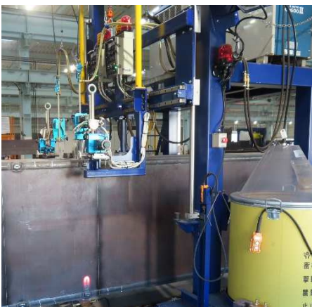
写真14 第二エレクトロスラグ溶接加工
