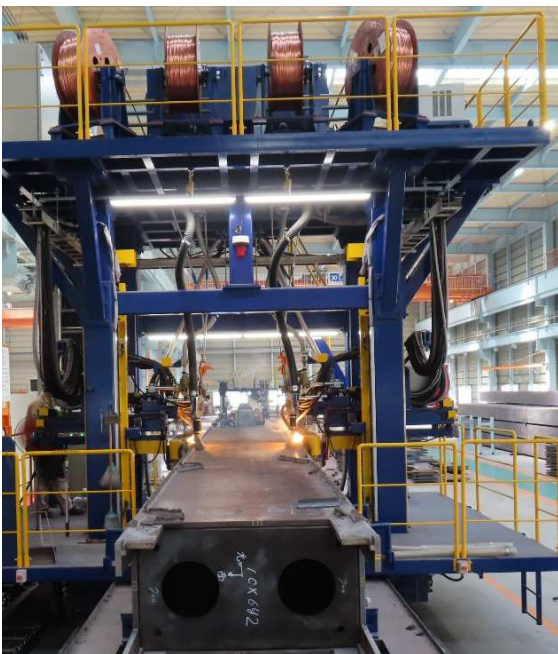
写真8 BOX柱角溶接装置
