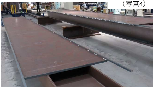
写真3 スキンプレートへの裏当金取付
