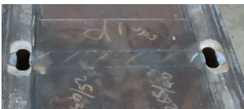
写真10 2個のキリ穴加工後ガス切断した長穴
