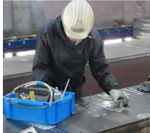
写真18 超音波探傷検査状況
