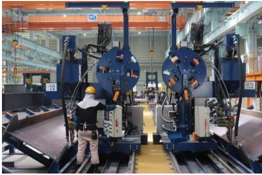
写真6 BH自動溶接装置と施工状況
